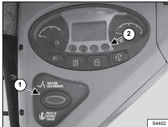
(Funziona solamente quando la barra di sicurezza del sedile è sollevata e il motore è acceso). Un pulsante di ESCLUSIONE DEL BLOCCO TRAZIONE (1) [Figura 21] è presente sul cruscotto sinistro. Esso permette di utilizzare i comandi dello sterzo per procedere in marcia avanti e retromarcia quando si utilizza il retroescavatore.
