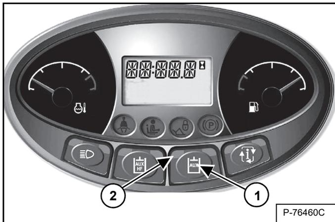
Premere una volta il pulsante dell'impianto idraulico ausiliario (1) [Figura 57] per attivare l'impianto idraulico ausiliario.
