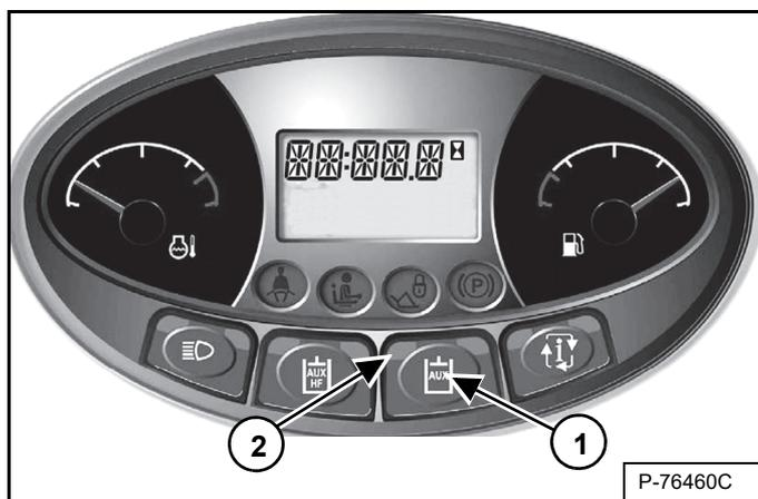
Premere una volta il pulsante dell'impianto idraulico ausiliario (1) [Figura 60] per attivare l'impianto idraulico ausiliario.
