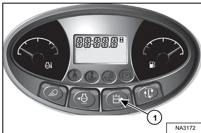
Premere il pulsante dell'impianto idraulico ausiliario (1) [Figura 64].
