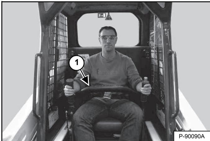
Il sistema di sicurezza del sedile è dotato di una barra innernata e di braccioli (1) [Figura 17].
