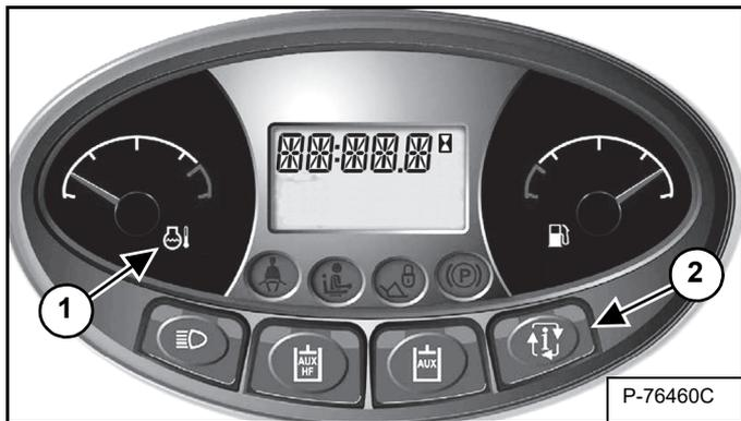
Controllare frequentemente gli indicatori della temperatura e del livello del carburante e le spie BICS™ (per poter utilizzare la pala caricatrice è necessario che le spie BICS™ siano tutte spente) [Figura 88].
