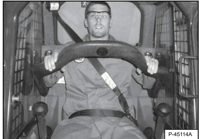
Abbassare la barra di sicurezza del sedile e inserire il freno di stazionamento [Figura 77].
