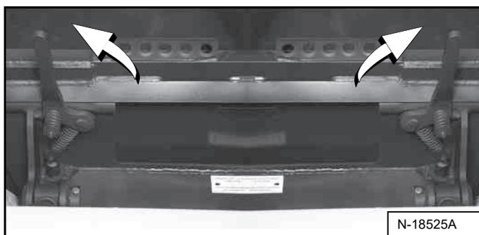
Tirare le leve del Bob-Tach verso l'alto [Figura 98] in modo che siano completamente sollevate (cunei completamente sollevati).
