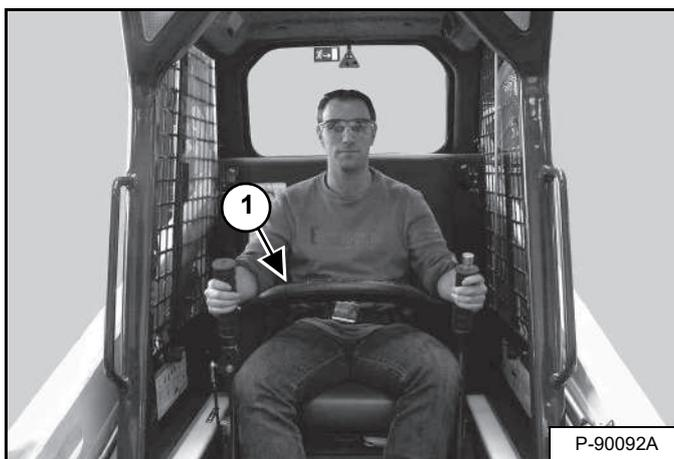
Il sistema BICS™ è dotato di barra basculante e di braccioli (1) [Figura 18]. La barra di sicurezza del sedile viene azionata dall'operatore.
