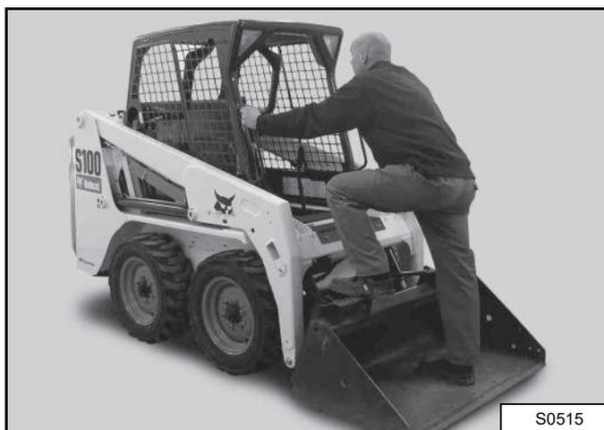
Per salire e scendere dalla pala caricatrice, utilizzare i gradini della benna o dell'accessorio, le maniglie e i gradini antidrucciolo (sul telaio e sui bracci di sollevamento della pala), mantenendo costantemente tre punti di contatto [Figura 70]. Non saltare.
