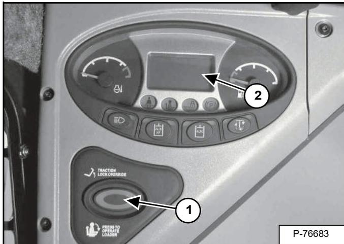
Premere il pulsante PREMERE PER AZIONARE LA PALA CARICATRICE (1) [Figura 82] per attivare il sistema BICS™ e le funzioni idrauliche e di manovra della pala caricatrice.
