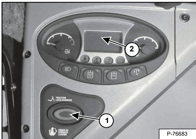
Premere il pulsante PREMERE PER AZIONARE LA PALA CARICATRICE (1) [Figura 87] per attivare il sistema BICS™ e le funzioni idrauliche e di manovra della pala caricatrice.
